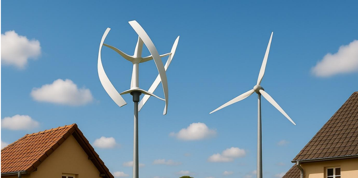
Rysunek 8. Przykłady małych turbin wiatrowych. Po prawej z poziomą osią obrotu, po lewej z pionową osią obrotu Źródło: opracowanie własne
